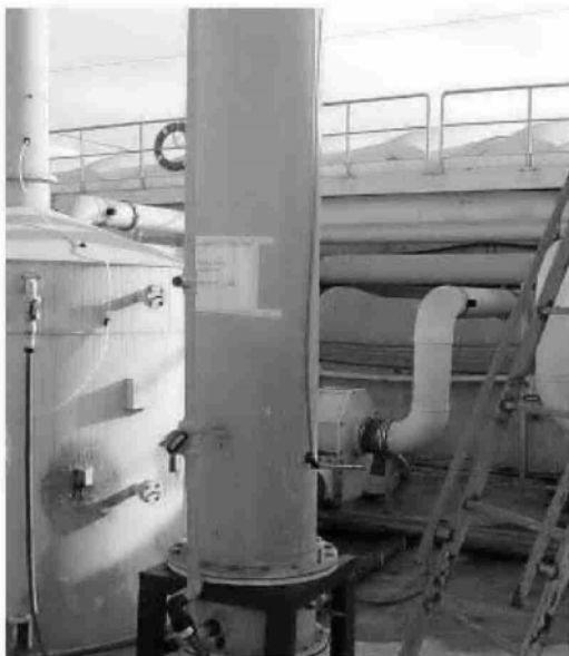
Torre donde se prueba el nuevo producto en la depuradora del Guadalhorce.
